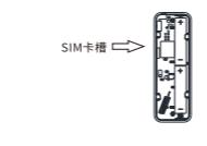
步骤1:(1)轻撬后盖(2)按照图示箭头方向推开后盖。
